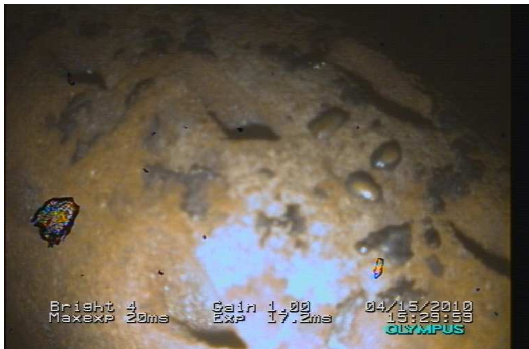
Cliché d'une ailette de turbine haute pression d'un des F-18. Les tâches noires sont de la cendre volcanique collée sur l'ailette. Les zones grises sont des canaux de refroidissement
