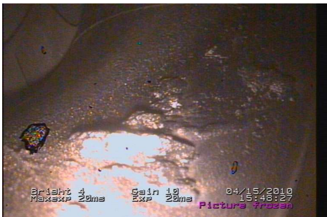
Chambre de combustion d'un F-18 Hornet. Les surfaces claires réfléchissant la lumière sont des amas créés par de la poussière volcanique collés dans la chambre de combustion.
